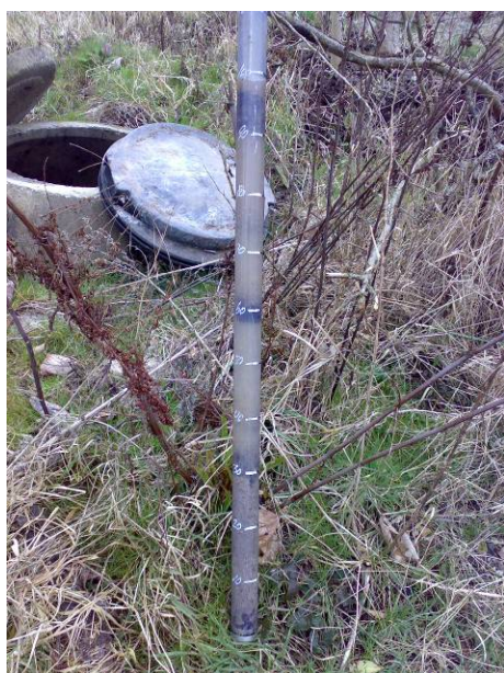
Foto 1. Slammåling med et slamrør
