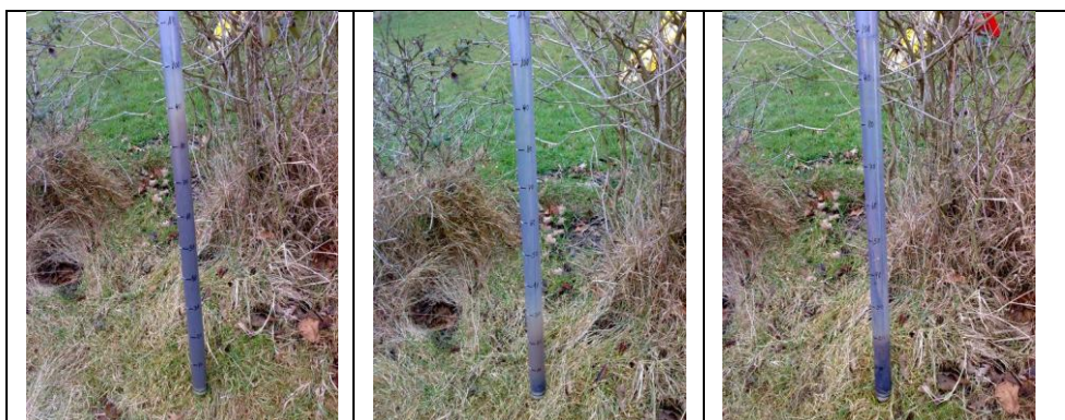
Billede 2, 3 og 4: Eksempel på slammåling i første, anden og tredje kammer af bundfældningstank
