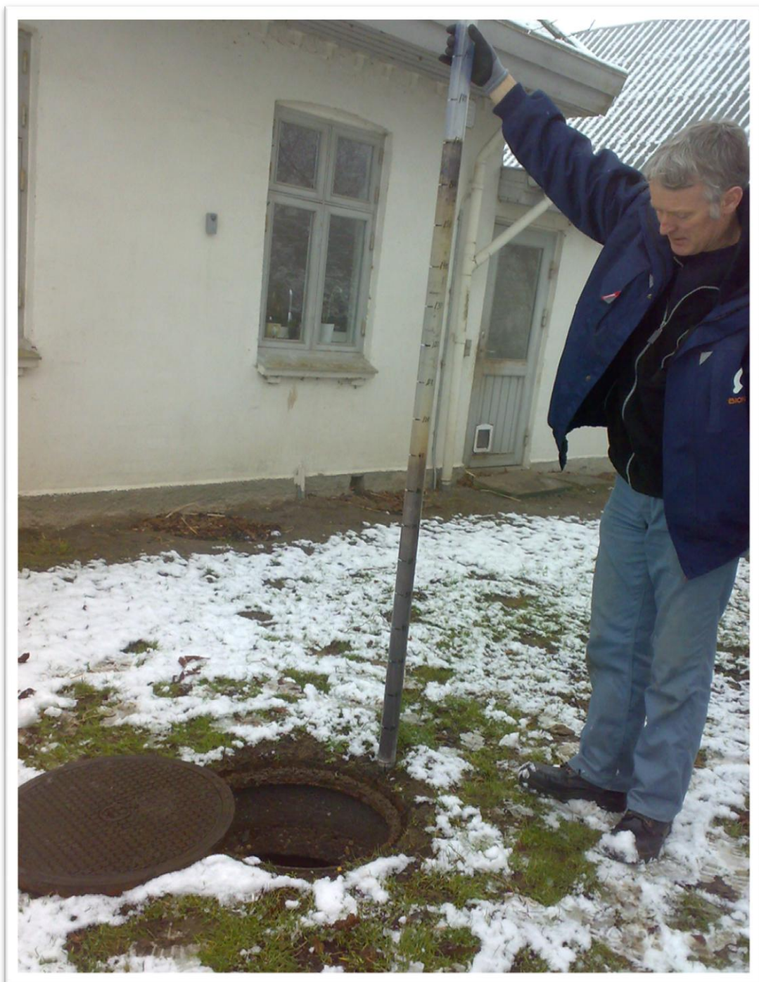
En Biokube servicetekniker måler slam med slamtester.
