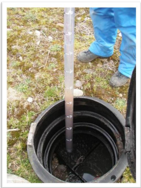
Billede 1: Slammåling med en BioKube slamtester.
