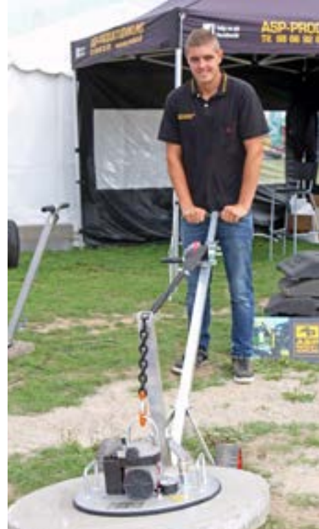
Simon Sørensen fra Asp Produktudvikling tager vakuum til hjælp, når der skal flyttes kloakdæksler og andet tungt.
