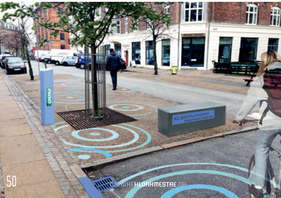
Den nye vandsortende vejbrønd kommer til at optræde som synligt element på vejene.
